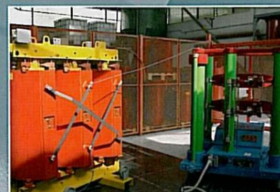
Prova a Impulso Atmosferico (Prova di Tipo)
