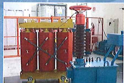
Prova a Tensione Applicata
